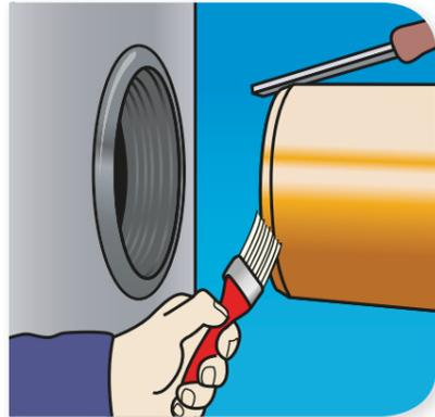
Chanfreiner chaque extrémité du tube à emboîter et lubrifier.
