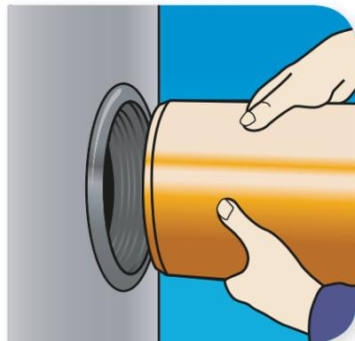
Centrer et assembler de manière à aligner l'extrémité du tube avec la paroi intérieure de l'élément en béton.
